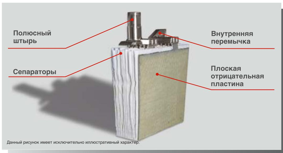
В АККУМУЛЯТОРАХ FIAMM FIT ПРИМЕНЯЕТСЯ ТЕХНОЛОГИЯ AGM (ABSORBED GLASS MAT – ПОРИСТЫЙ ЗАПОЛНИТЕЛЬ ИЗ СТЕКЛОВОЛОКНА). ЭЛЕКТРОЛИТ ПОЛНОСТЬЮ ВПИТЫВАЕТСЯ В СТЕКЛОВОЛОКОННЫЙ СЕПАРАТОР, ЭФФЕКТИВНОСТЬ РЕКОМБИНАЦИИ ГАЗОВ СОСТАВЛЯЕТ 99%. БЛОКИ ОТЛИЧАЮТСЯ ПРОЧНОСТЬЮ, ГЕРМЕТИЧНОСТЬЮ И НЕ ТРЕБУЮТ ДОЛИВКИ ЭЛЕКТРОЛИТА В ТЕЧЕНИЕ ВСЕГО СРОКА СЛУЖБЫ. НИЗКИЙ УРОВЕНЬ САМОРАЗРЯДА ПОЗВОЛЯЕТ ХРАНИТЬ БАТАРЕИ БЕЗ ЗАРЯДКИ ДО 6 МЕСЯЦЕВ.
